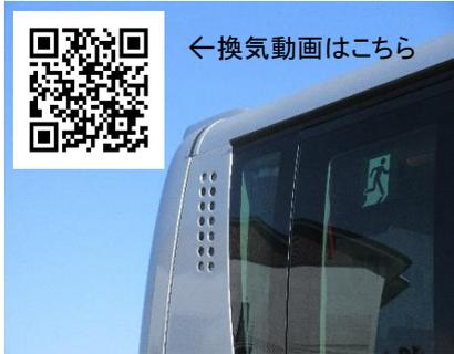
貸切、高速、急行バスは、空調を外気導入にすることで、車内換気しています。
