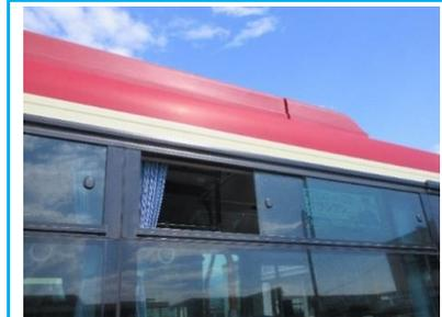
空調は外気導入（貸切、高速）、窓開け換気も併用（路線バス）しています。
